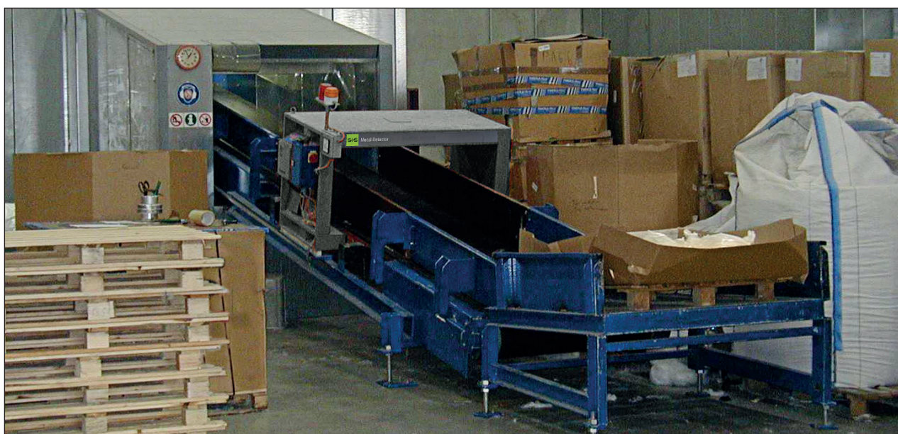
安裝示例：隧道式金屬探測器DLS在造粒機之前檢測回收材料。（舊版）
