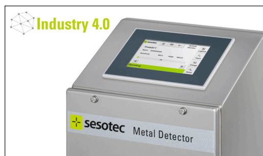
電子控制單元GENIUS ONE，帶5英寸彩色觸控螢幕（支援工業4.0 / 支援物聯網）
