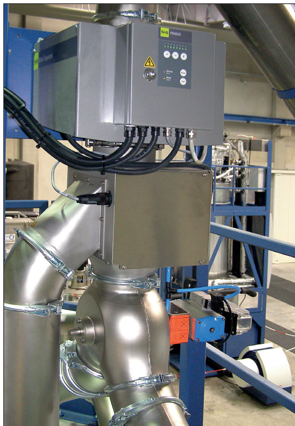
安裝示例：金屬分離器RAPID VARIO-FS用於PET再生的質量控制。（舊版）
