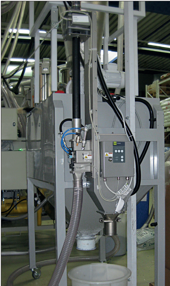
安裝示例：金屬分離器GF安裝在垂直管道中（舊版本）
